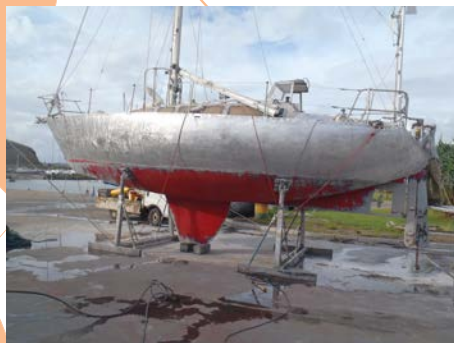
Fin du décapage
