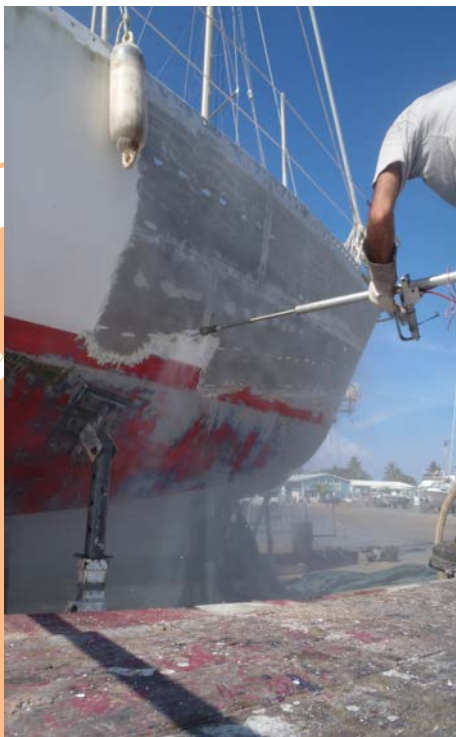
Décapage ancien revêtement
