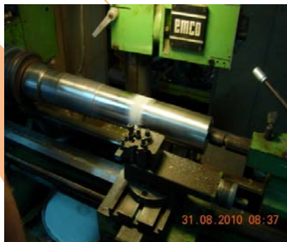
Usinage du rechargement
