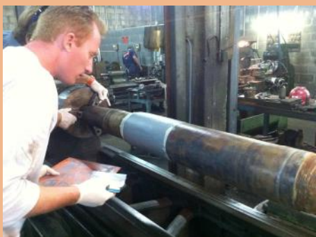
Reconstruction de l'arbre avec un polymère de chez BELZONA 1111 S-METAL.
