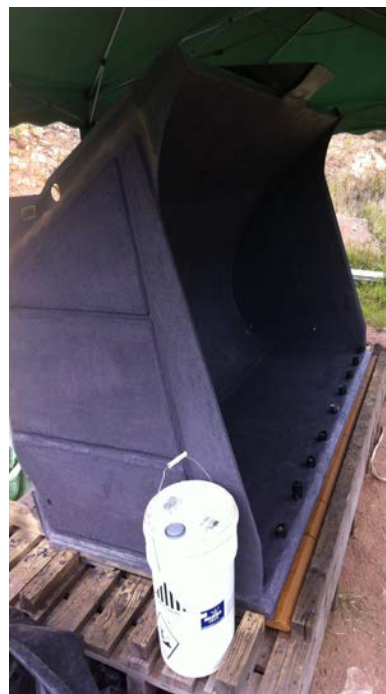
Après application du BELZONA 1812 sur l'ensemble du godet.
