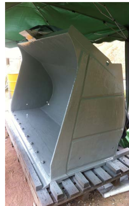
Mise en peinture de l'équipement à la l'EPOXY renforcée en écaille de verre .
