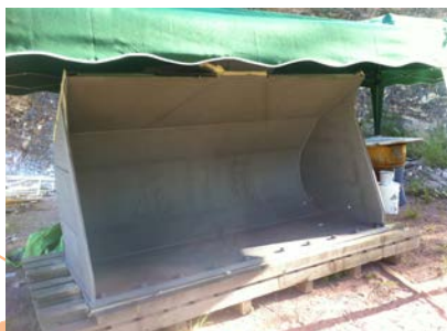
Préparation de la surface par sablage.
